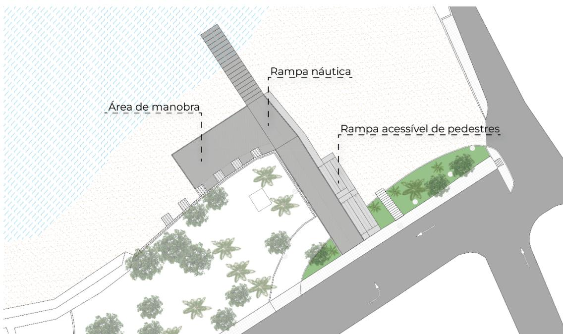
Figura 2 – *Layout* do anteprojeto da rampa náutica com rampa acessível de pedestres
