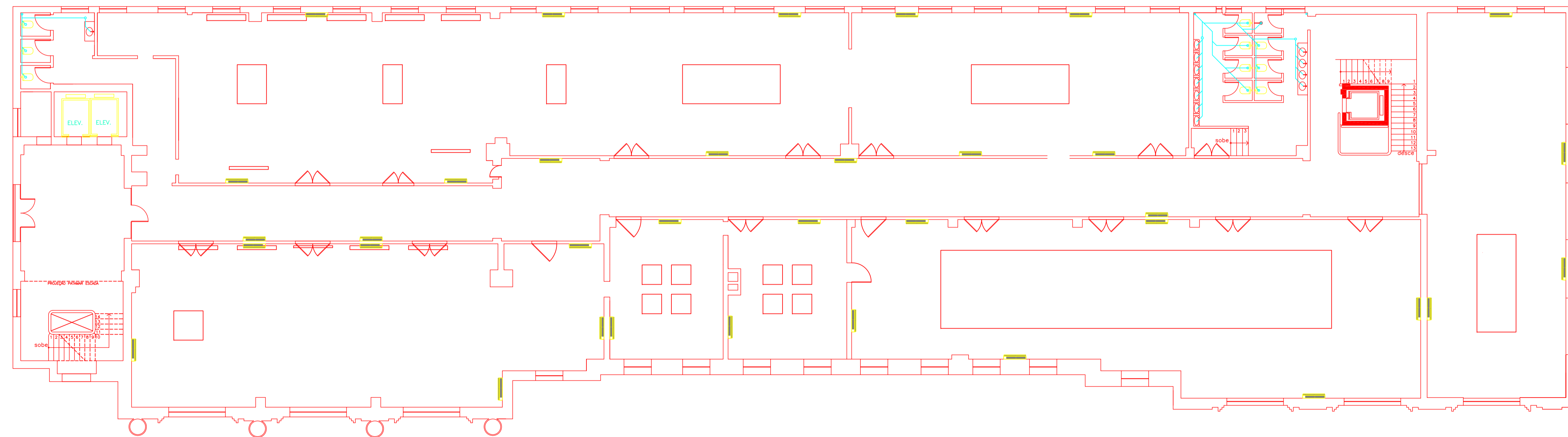
05 PLANTA PAV. TERCEIRO - REDE DE SPRINKLER'S ESC.: 1/125
