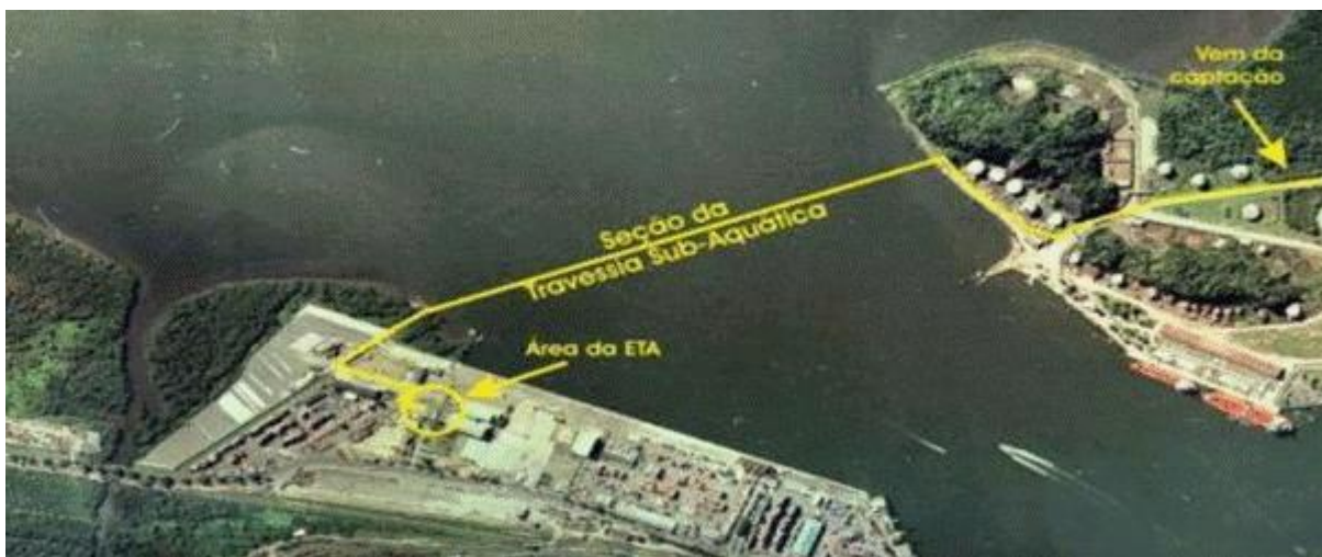
Foto 2 – Caminhamento da adutora de água bruta
