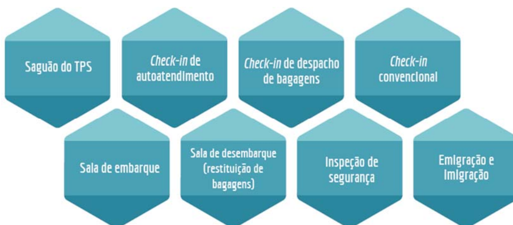
Figura 10 – Componentes operacionais dos terminais aeroportuários de passageiros Fonte: IATA (2014). Elaboração: LabTrans/UFSC (2018)
