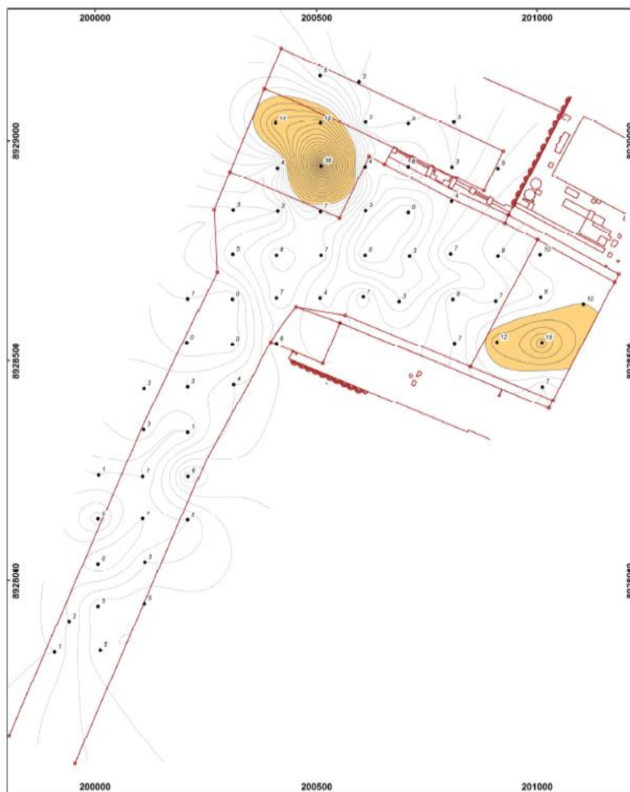
Figura 24 - Mapa de Resistências máximas do Solo até a profundidade de Projeto INPH-220 10D. Fonte: INPH, 2013.
