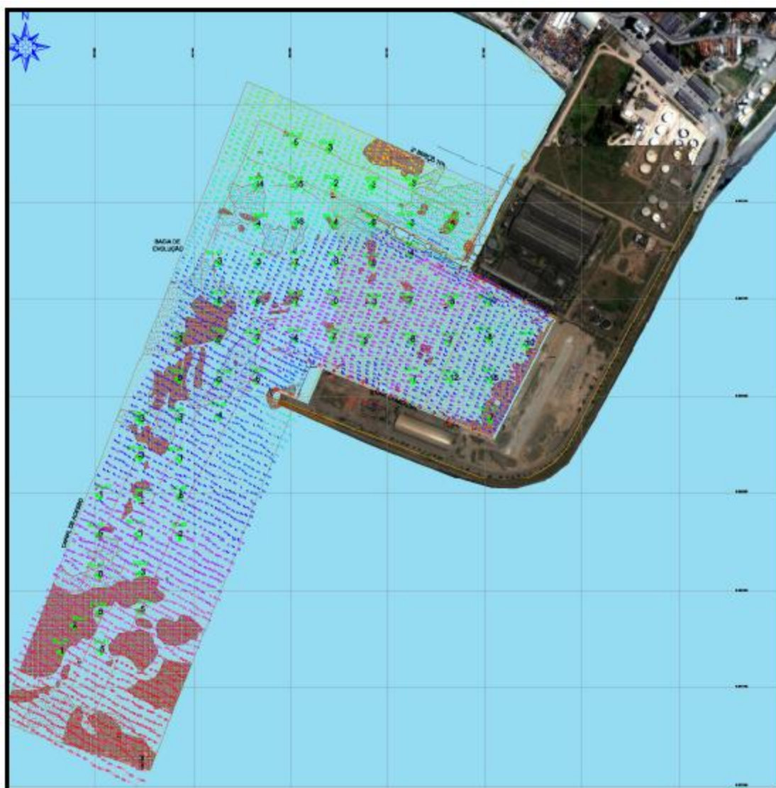
Figura 23 - Planta de integração de dados geofísicos e geológicos do Porto de Maceió Fonte: INPH, 2013.
