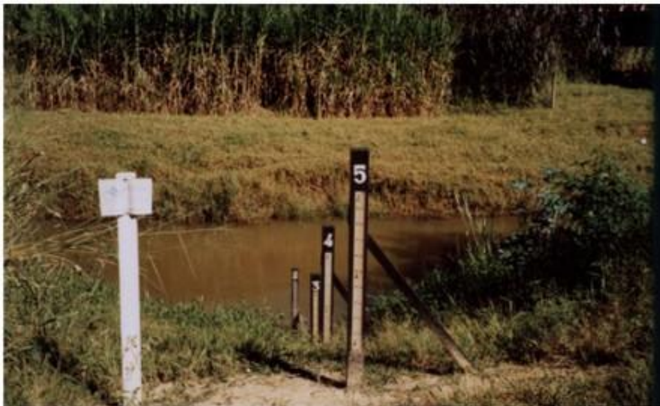
Figura 5 – Exemplo ilustrativo de instalação de lances de régua em uma seção de rio.
