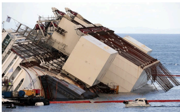
Figura 4 – Strand jacks (visão de popa) utilizados na salvatagem do Costa Concordia 2 . A figura ilustra também a estrutura auxiliar confeccionada lateralmente ao casco para dar segurança à operação
