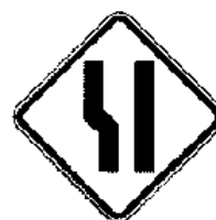
A-21d Alargamento de pista à esquerda
