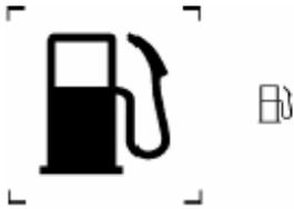
Esta lâmpada piloto deve entrar em funcionamento quando o combustível do reservatório do veículo estiver próximo ao esgotamento.
