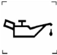
Esta lâmpada piloto deve entrar em funcionamento quando a pressão de óleo, no circuito de lubrificação do motor, for inferior ao limite normal de funcionamento estabelecido pelo fabricante do veículo.
