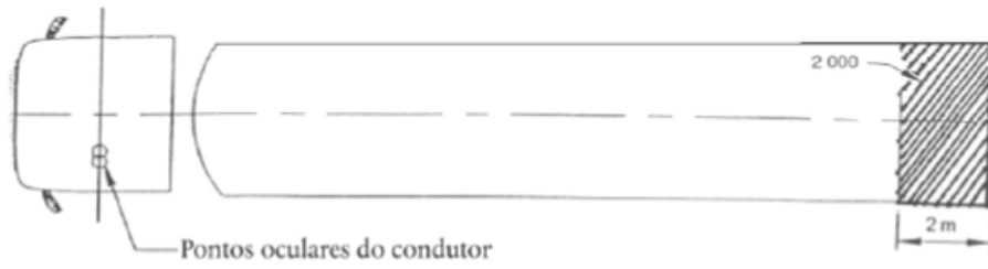
Figura 12: Campo de visão dos dispositivos para visão indireta instalados à retaguarda
