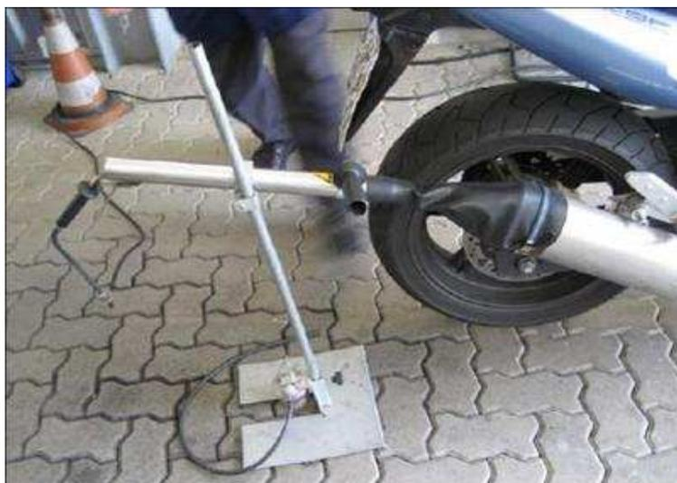
**Figura III - Adaptador interno**
