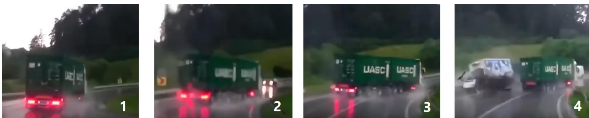
Figura 3 – Efeito Chicote em pista escorregadia [7]
