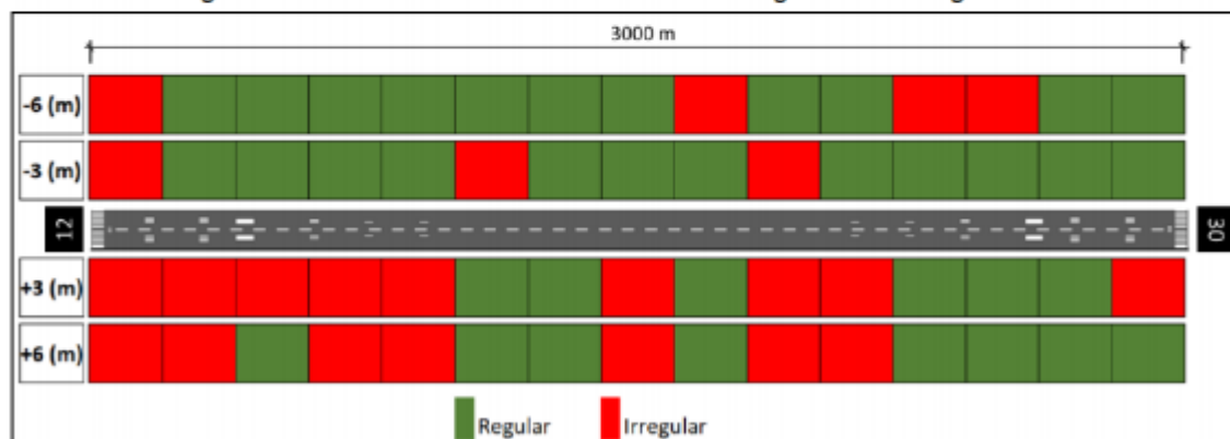
Figura 2-162: Resultados dos Levantamentos das Irregularidades Longitudinais
