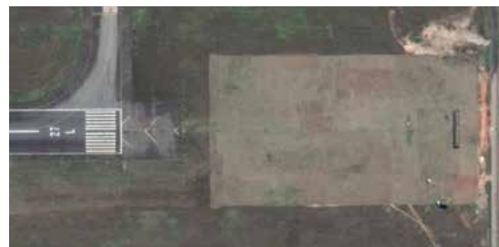
Figura 2-16: Exemplo de RESA na cabeceira 27L do aeroporto de Guarulhos - SP (fonte: Google Earth)
