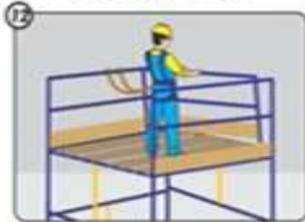
12 Piso com forração completa, antiderrapante, nivelado e fixado de modo seguro e resistente
