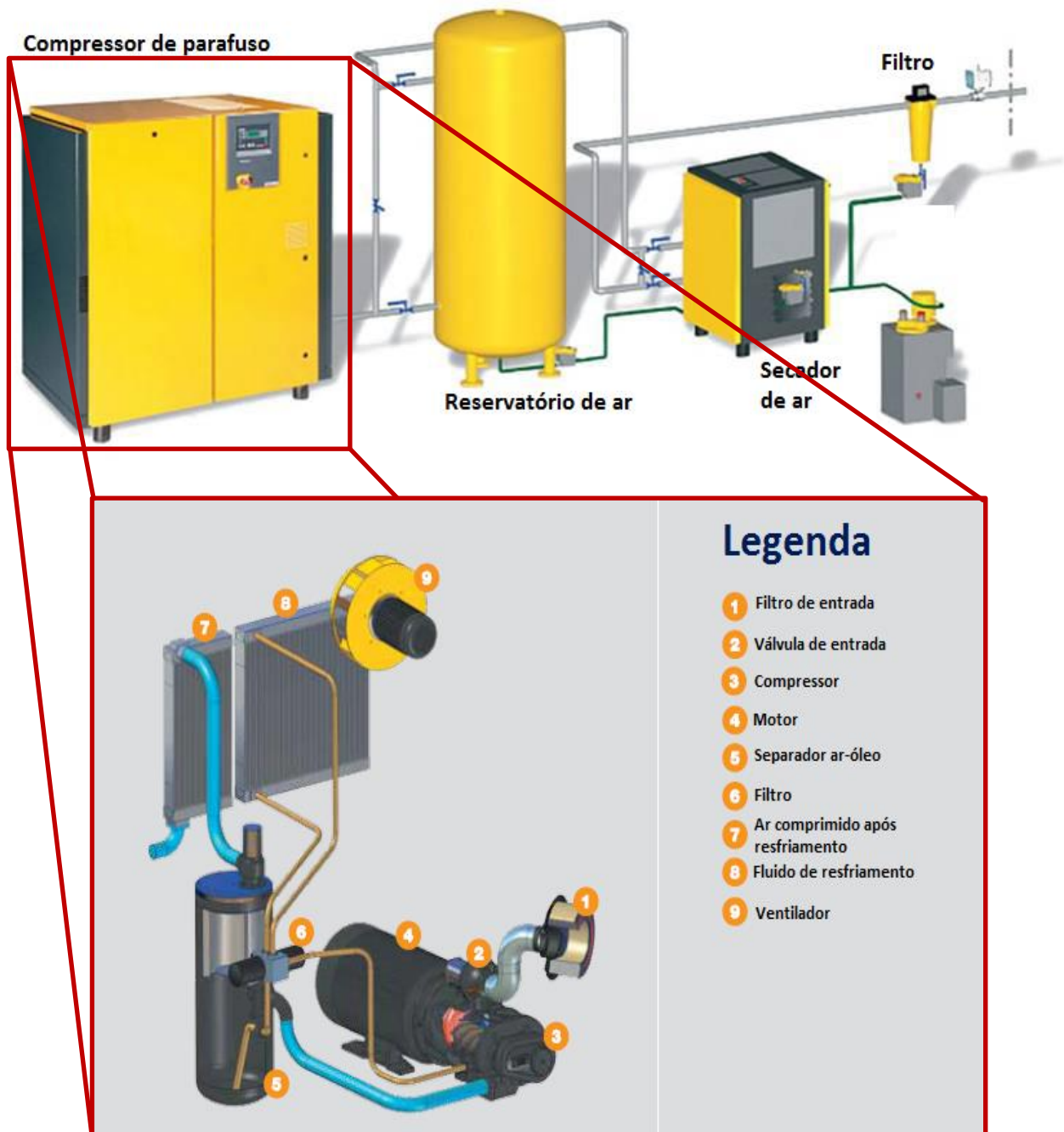
Figura 11 – Componentes internos do compressor de parafuso estacionário
