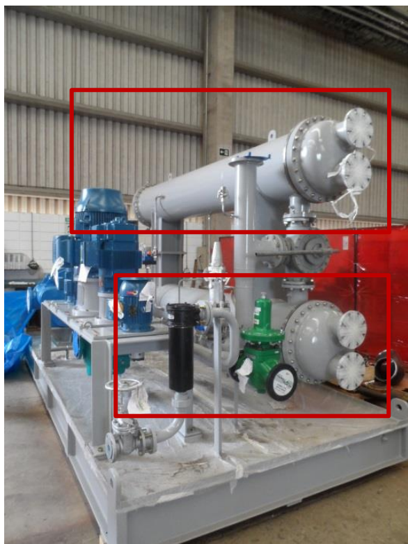
Figura 6 – Vaso de pressão de sistema de lubrificação de turbinas a vapor, fornecido com skid independente
