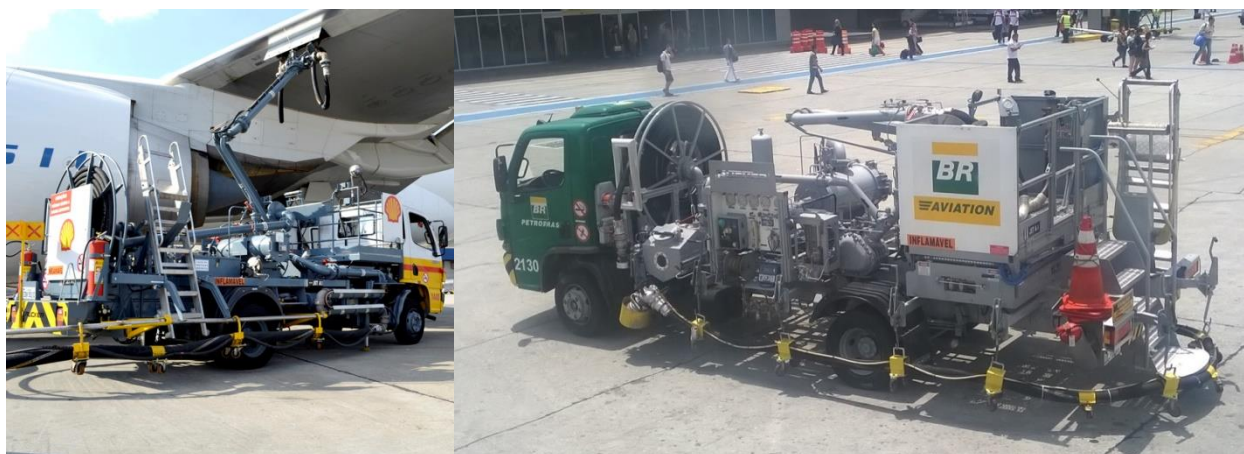
Figura 16 - Filtros e vasos de pressão instalados em caminhões devem ser enquadrados como móveis
