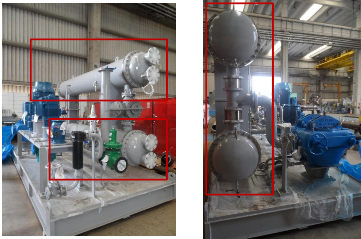
Figura 6 – Vaso de pressão de sistema de lubrificação de turbinas a vapor, fornecido com skid independente
