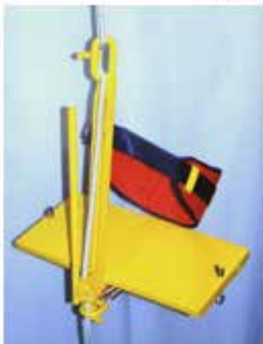
dispositivo de descida com dupla trava de segurança sustentada por cabo de fibra sintética
