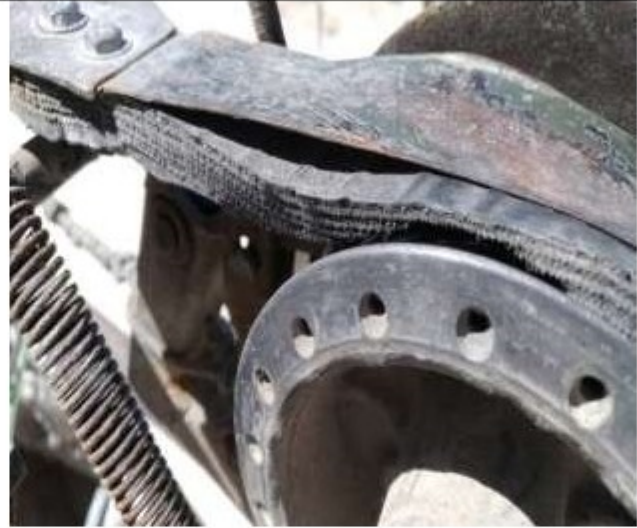
Cinta de borracha desgastada, utilizada para frear o guincho
