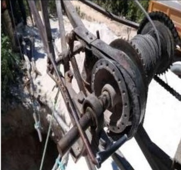
Carretel e sistema de frenagem
