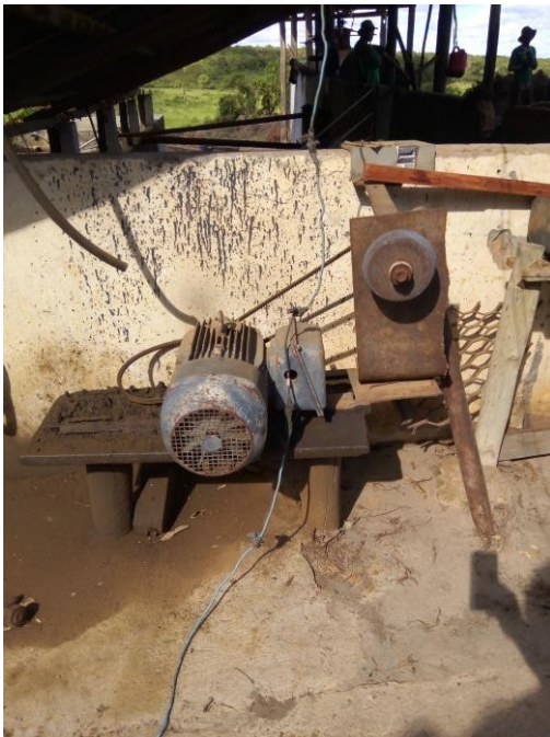
Equipamentos com transmissões de força sem proteção
