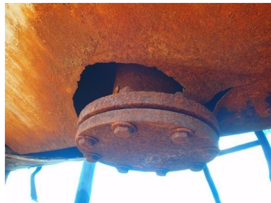
Partes deterioradas na estrutura da caldeira
