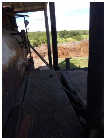
Risco de quedas em buraco no piso e inexistência de guarda-corpo em altura
