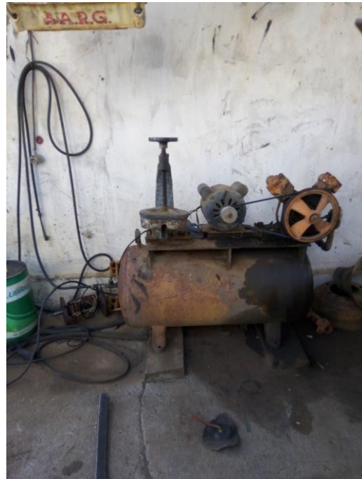
Equipamentos com transmissões de força sem proteção
