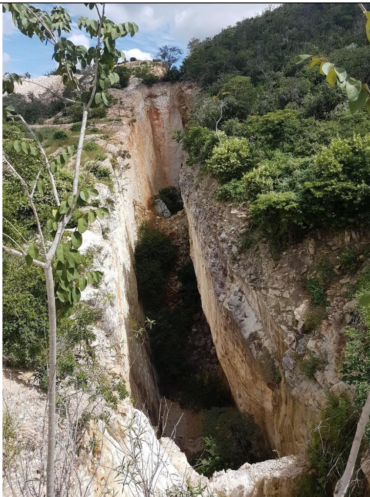
Vista geral da mina onde a atividade de extração ocorria, com taludes negativos e material proveniente de deslizamentos
