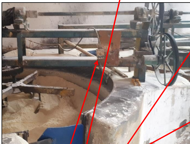
Fotos: Disjuntores e chaves reversoras que eram utilizados para acionar as máquinas da casa de farinha.
