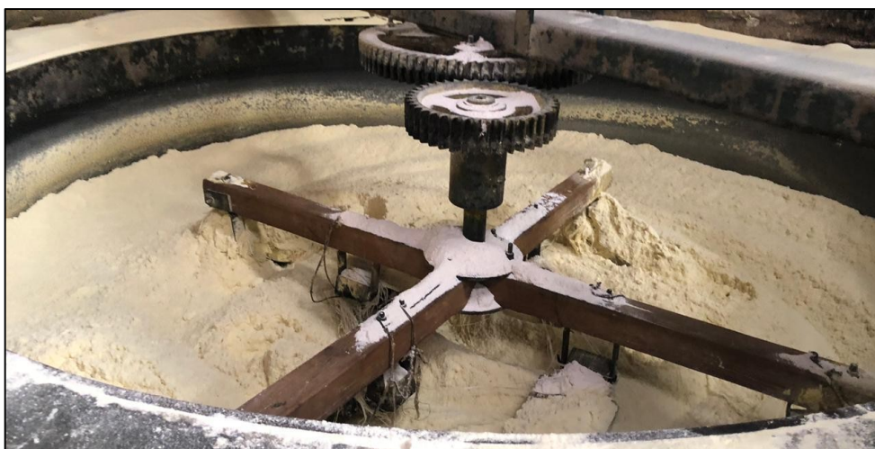
Foto: Zonas de perigo expostas de um dos fornos da linha de produção da casa de farinha.
