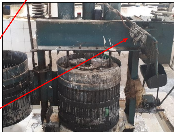
Fotos: Disjuntores e chaves reversoras que eram utilizados para acionar as máquinas da casa de farinha.
