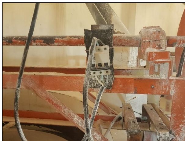
Fotos: Disjuntores e chaves reversoras eram utilizados para acionar as máquinas da casa de farinha.
