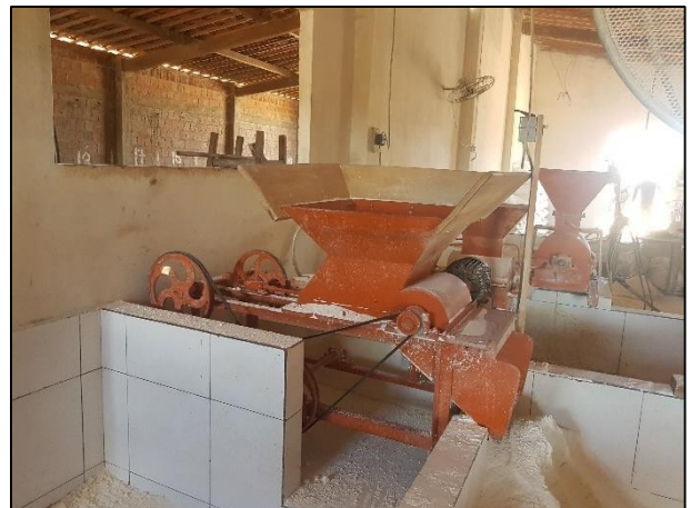
Fotos: Zonas de perigo das máquinas expostas. À esquerda, fornos de secar farinha. À direita, triturador de massa.
