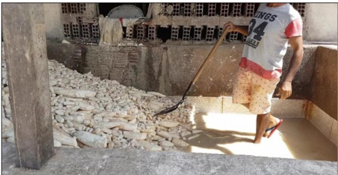
Foto: Trabalhador executando atividade dentro de caixa com manípueira, sem ut
