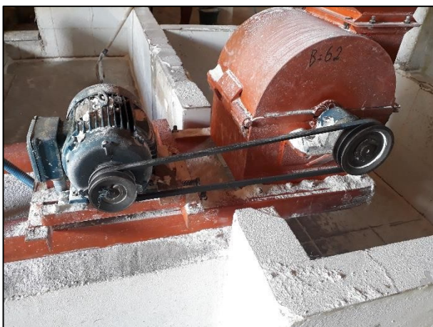
Fotos: Transmissões de força desprotegidas em máquinas da casa de farinha.
