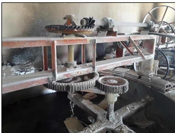
Foto: Zonas de perigo das máquinas expostas.
