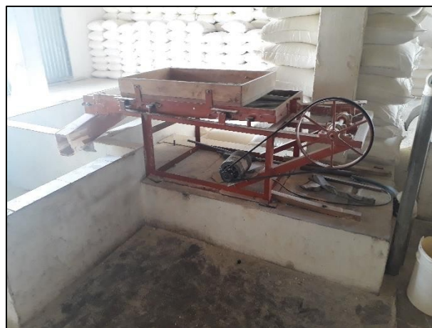
Foto: Zonas de perigo das máquinas expostas.
