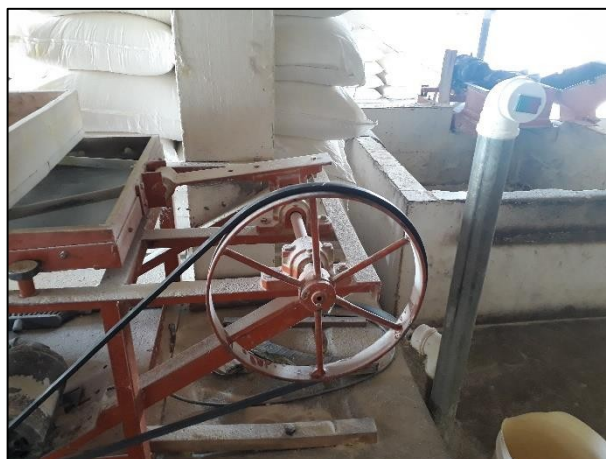
Fotos: Transmissões de força desprotegidas em máquinas da casa de farinha.
