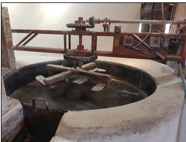
Fotos: Zonas de perigo de duas máquinas da linha de produção expostas. Acima, forno de secar farinha. À direita, transportador contínuo de rosca.
