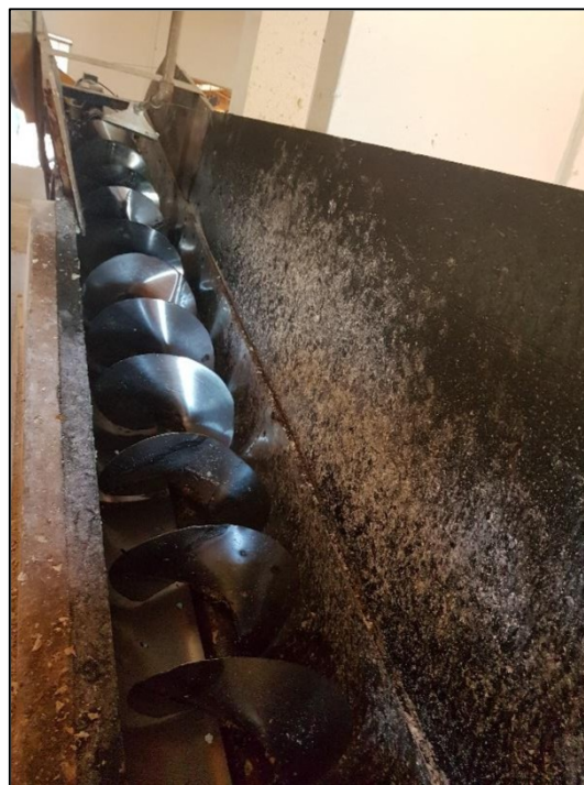
Fotos: Zonas de perigo de duas máquinas da linha de produção expostas. Acima, forno de secar farinha. À direita, transportador contínuo de rosca.
