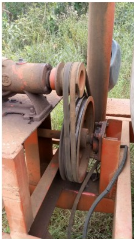
Foto das transmissões de força mecânica do tanque pipa expostas
