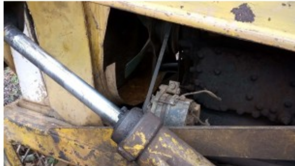
Transmissões de força mecânica dos tratores expostas
