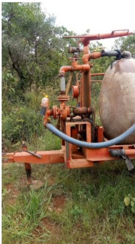
Foto das transmissões de força mecânica do tanque pipa expostas
