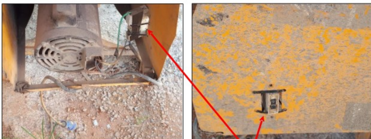
Fotos: O dispositivo de acionamento e parada da betoneira era um disjuntor termomagnético.
