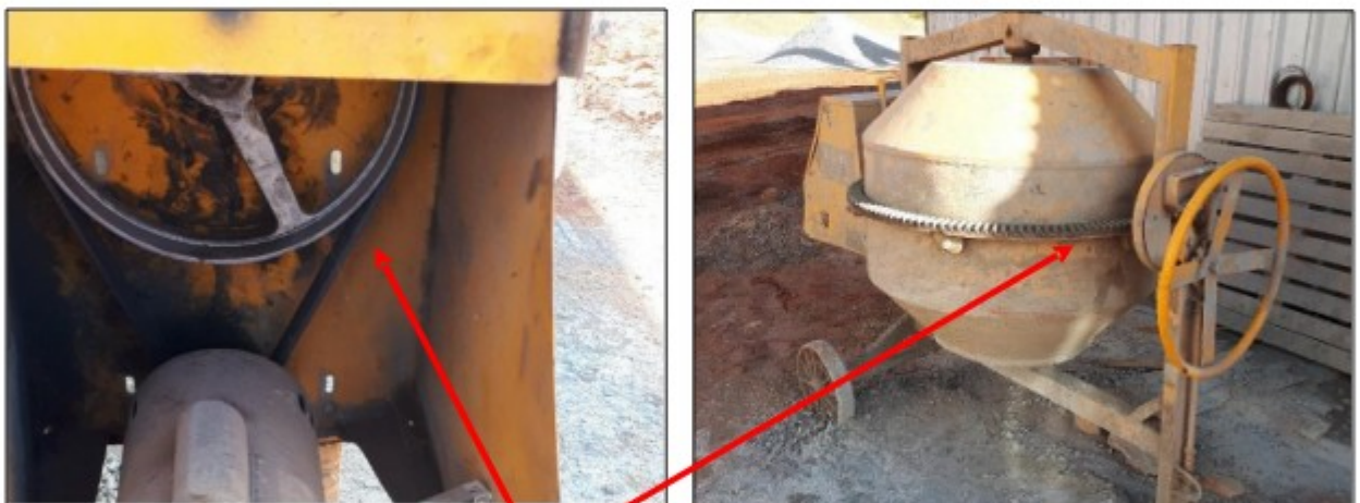
Fotos: Transmissões de força da betoneira desprotegidas.
