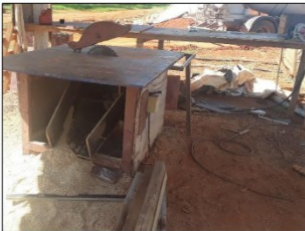
Fotos: Cabeamento elétrico da serra circular, sem qualquer proteção e solto no piso do setor de carpintaria da obra.
