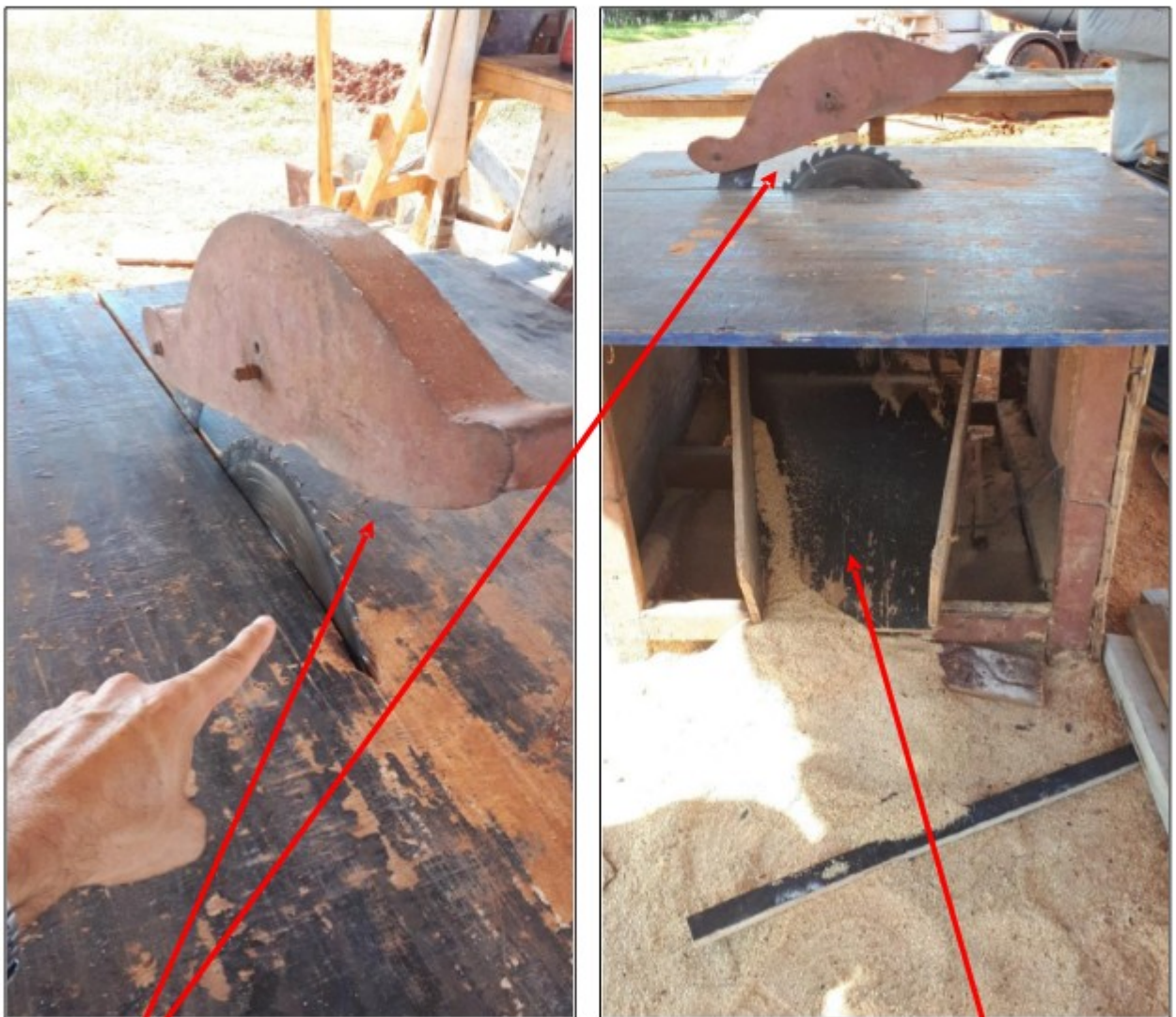
Fotos: A coifa instalada na serra circular não protegia toda a extensão da área de corte; não havia coletor de serragem no equipamento.
