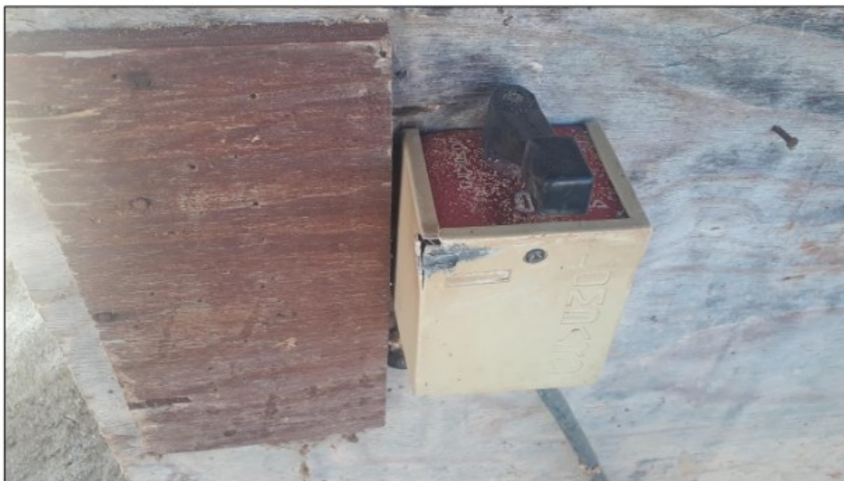
Foto: Chave tipo Lombard que era utilizada para acionar e desligar a serra circular.
