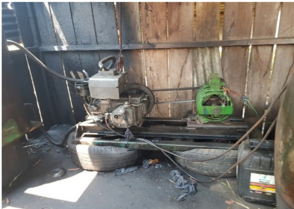
Figura 18: gerador com transmissão de força exposta.
