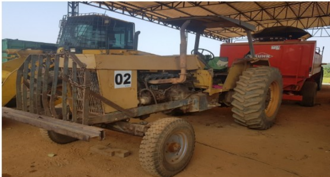
Figura 20: Trator sem EPC e sem cinto de segurança.
