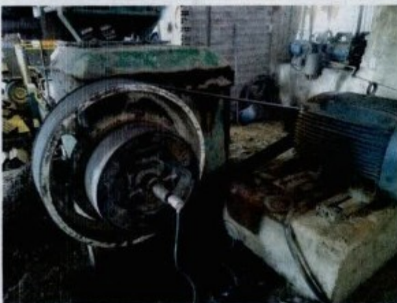
Foto à esquerda: transmissão de força da máquina sem proteção; foto à direita: fiações elétricas irregulares
