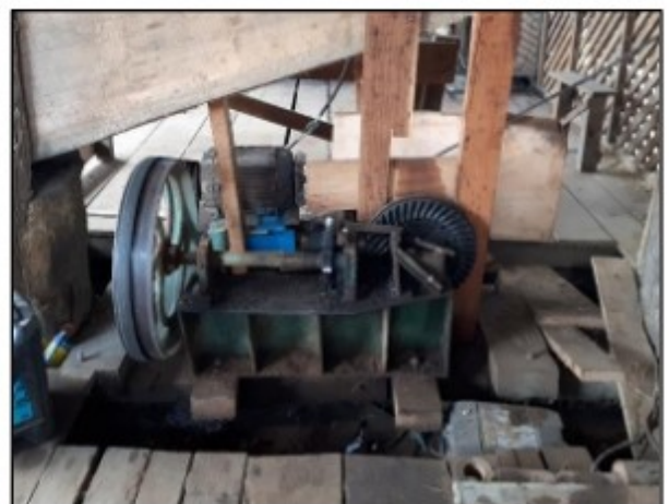
Fotos: Exemplos de algumas máquinas sem proteção fixa em transmissões de força (à esquerda: motor de tração do vagonete de toras; à direita: guincho)
