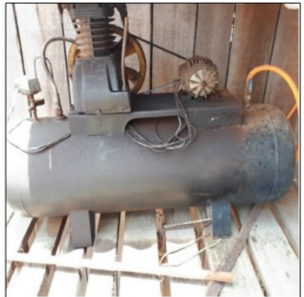
Fotos: Vaso de pressão instalado sem os requisitos legais de segurança determinados pela NR 13.
