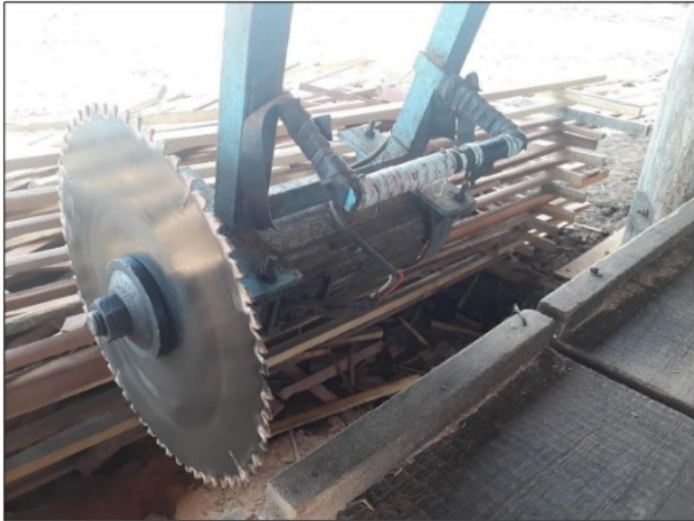
Fotos: Serra fita vertical de grande porte (primeira) e destopadeira (segunda), ambas sem proteções das zonas de risco.
