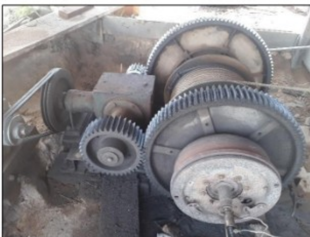
Fotos: Exemplos de algumas máquinas sem proteção fixa em transmissões de força (à esquerda: motor de tração do vagonete de toras; à direita: guincho)
