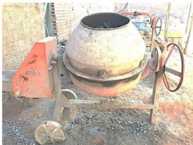
Fotos 41 e 42 – betoneira com ligação elétrica direta dos cabos de força à rede elétrica externa, sem chaves, disjuntores ou botoeiras
