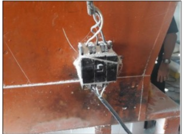
Imagens: Comandos de partida de duas máquinas da linha de produção, chave tipo “Lombard” e disjuntor, ambos proibidos pela legislação.
