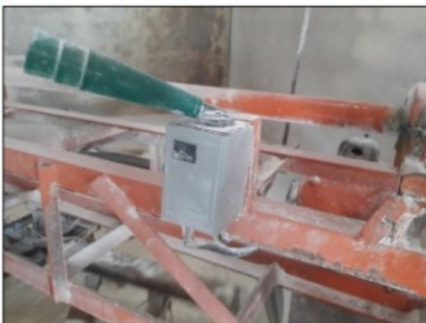
Imagens: Chaves de acionamento dos motores dos fornos localizadas ao lado das transmissões de força.
