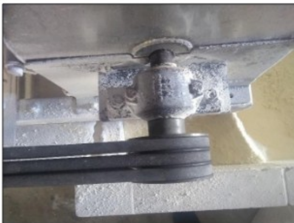
Imagens: Transmissões de força das máquinas completamente expostas.
