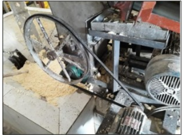
Imagens: Transmissões de força das máquinas completamente expostas.
