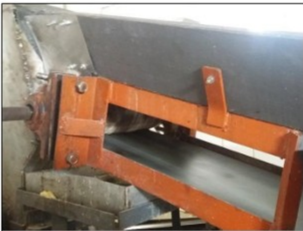
Imagens: Zonas perigosas dos transportadores contínuos sem proteção.
