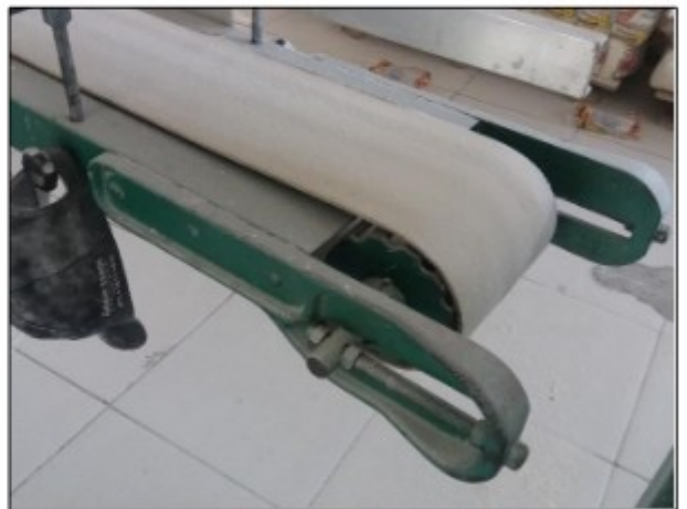
Imagens: Zonas perigosas dos transportadores contínuos sem proteção.
