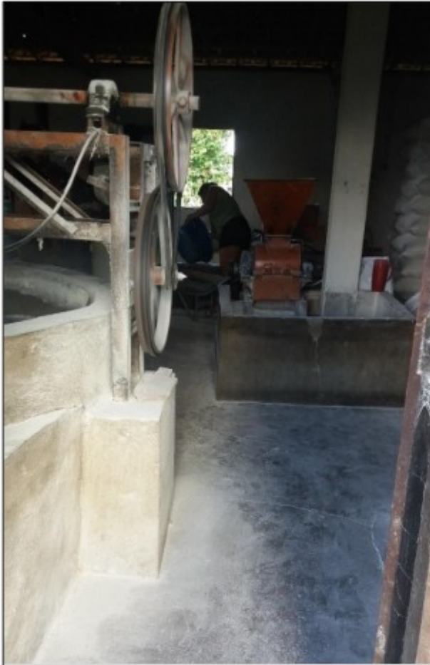
Imagens: Transmissões de força das máquinas completamente expostas.
