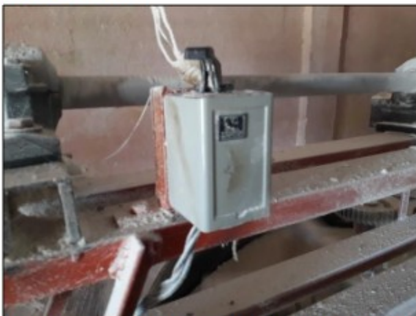
Imagens: Comandos de partida de duas máquinas da linha de produção, chave tipo "Lombard", cujo uso é proibido pela legislação.
