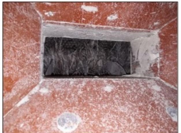
Imagens: Zonas de perigo das máquinas sem qualquer tipo de proteção.
