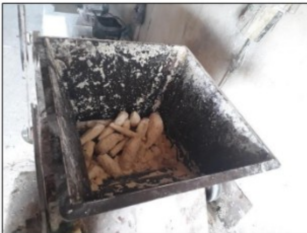
Imagens: Zonas de perigo das máquinas sem qualquer tipo de proteção.
