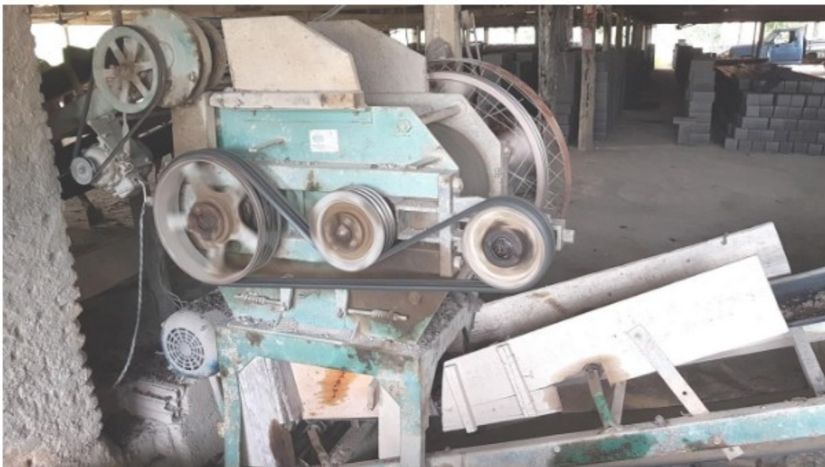
Foto 4- Máquina da Cerâmica Prado: transmissões de força (polias e correis) sem proteção .
