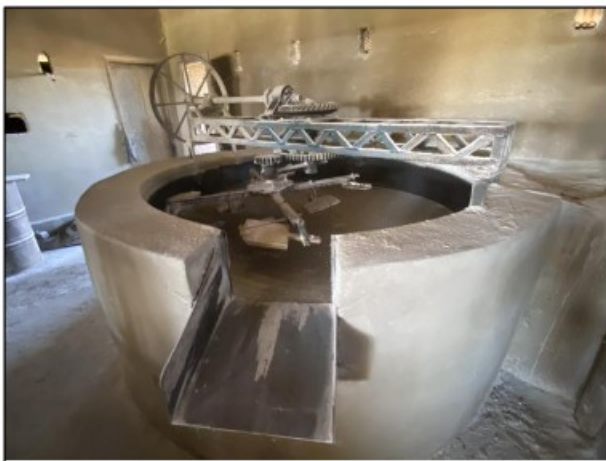
Imagens acima: Zonas de perigo (pás dos fornos) sem qualquer proteção.
