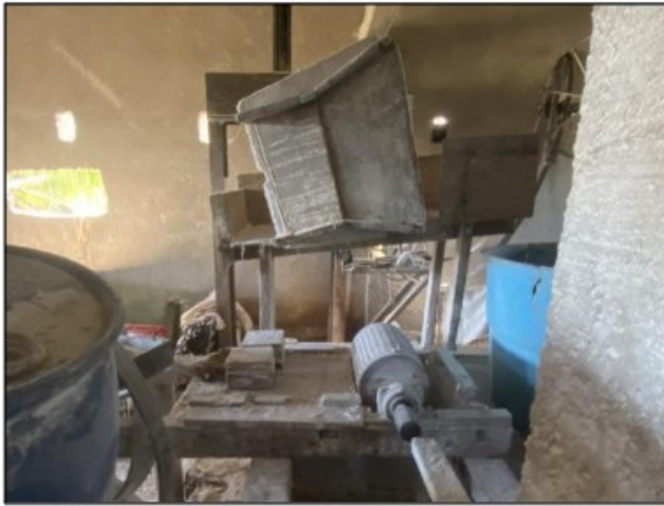
Imagens acima: Zonas de perigo (cilindro da cevadeira) sem qualquer proteção.
