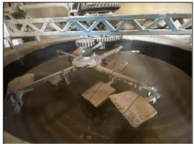
Imagens acima: Zonas de perigo (pás dos fornos) sem qualquer proteção.
