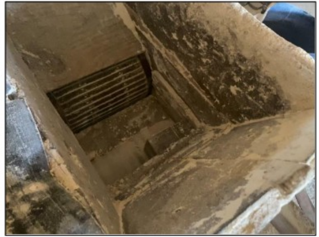
Imagens acima: Zonas de perigo (cilindro da cevadeira) sem qualquer proteção.
