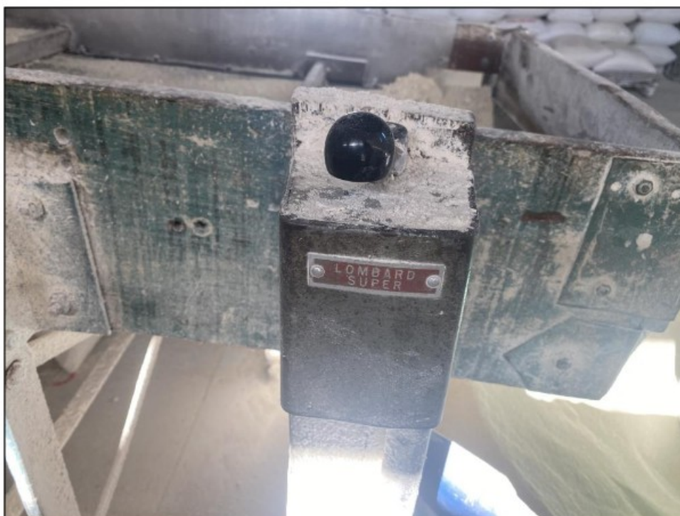
Imagem acima: Chave tipo "Lombard" que era usada para acionar a peneira classificadora da Fábrica.
