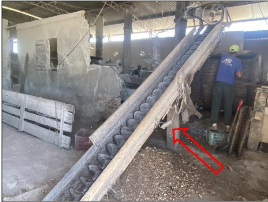
Imagem acima: Conjunto plug/tomada que servia para acionamento da rosca sem fim.
