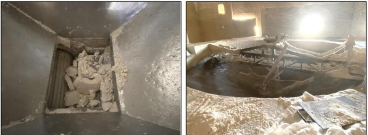
**Imagens acima:** Zonas de perigo das máquinas (cilindro da cevadeira e pás de um dos fornos) sem qualquer proteção.
