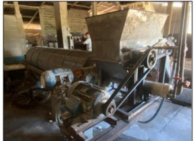
**Imagens acima:** Transmissões de força das máquinas completamente expostas e acessíveis aos trabalhadores.
