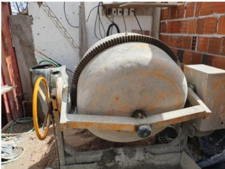
*Figura 19 Betoneira sem sistema de bloqueio e de parada de emergência.*
