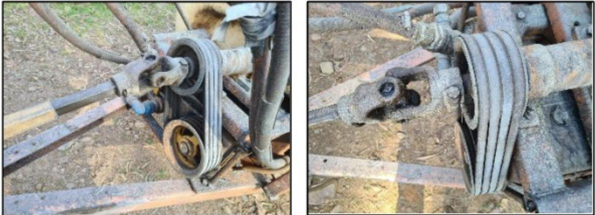
*Figura 6 – Eixo cardã sem proteção.*
