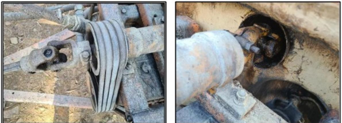
*Figura 7 – Transmissão de força sem proteção.*
