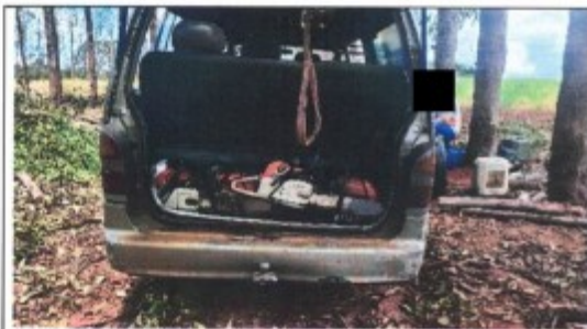
Foto 33 – ausência de compartimentos isolados para transporte de motosserras e ferramentas de trabalho.
