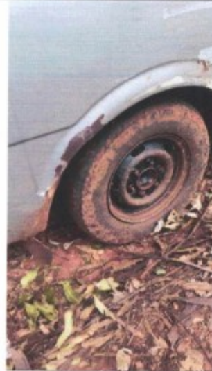
Foto 30 – pneu traseiro direito extremamente desgastado.
