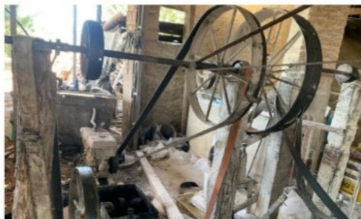
Máquinas sem proteção
