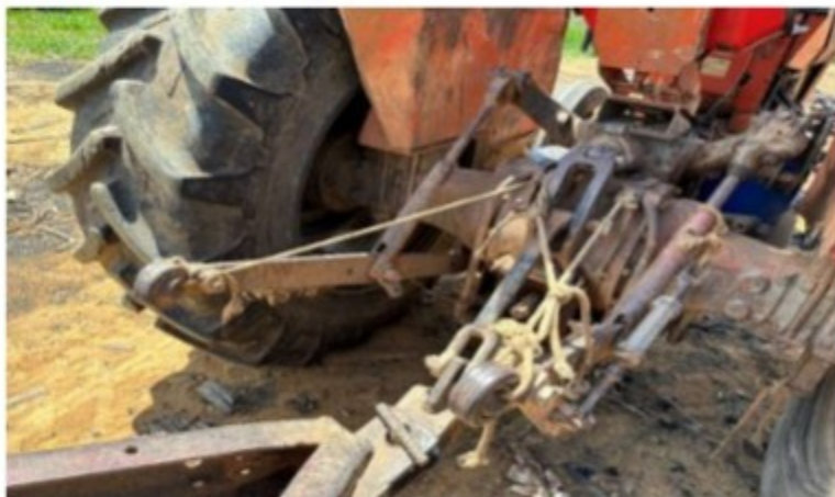
Figura 7 trator da marca Massey Ferguson modelo 265, sem proteção na Tomada de Potência
