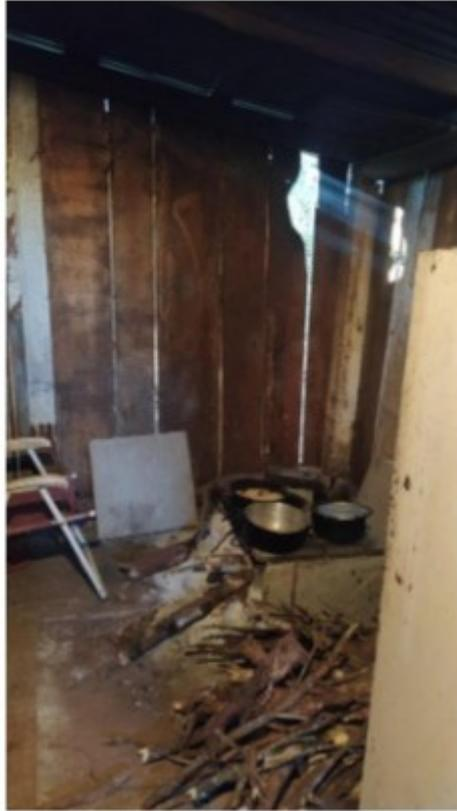
*(fogão improvisado instalado na área interna do alojamento, sem sistema de exaustão (chaminé), expondo os alojados ao desconforto respiratório, ao risco de intoxicação e ao risco de incêndio)*
