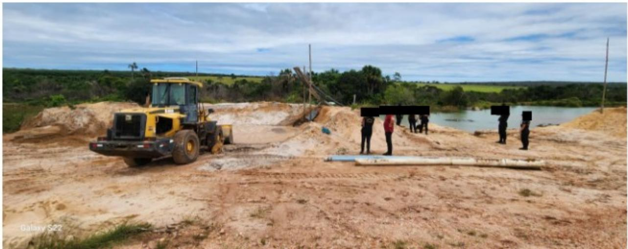
**Imagem 02** – Máquina pá carregadeira usada para carregar areia extraída no local nos caminhões.
