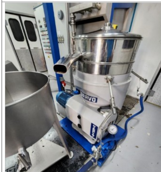
Centrifuga. Na parte superior dessa máquina o fechamento da zona de perigo era realizado apenas por meio de ganchos ou travas que podiam facilmente ser abertos de forma manual
