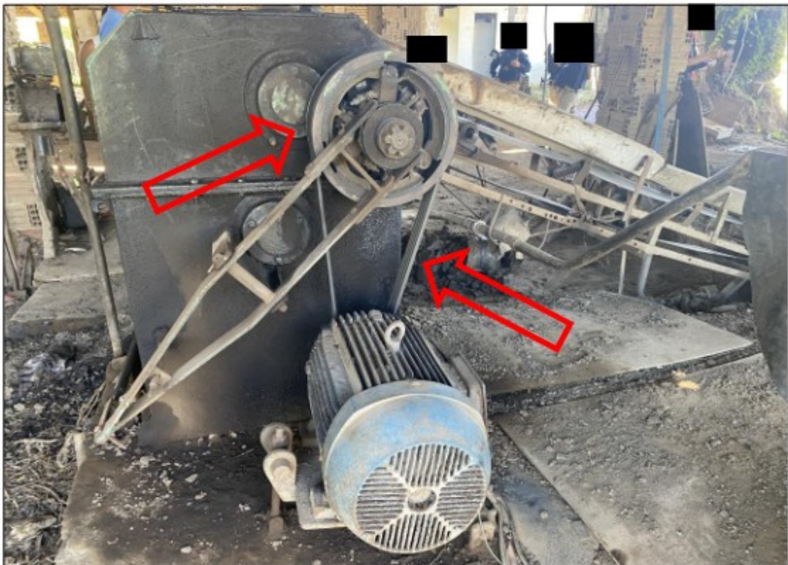
Foto acima: Transmissões de força do segundo misturador de barro, sem qualquer proteção.
