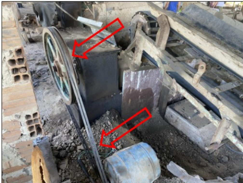
Foto acima: Transmissões de força do primeiro misturador de barro, sem qualquer proteção.
