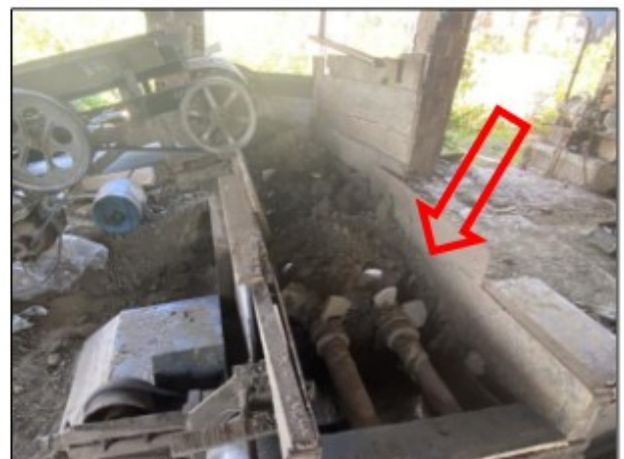
Fotos acima: Zonas de perigo do primeiro transportador contínuo (à esquerda) e do misturador de barro (à direita) desprotegidas.
