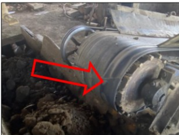
Fotos acima: Zonas de perigo do primeiro transportador contínuo (à esquerda) e do misturador de barro (à direita) desprotegidas.
